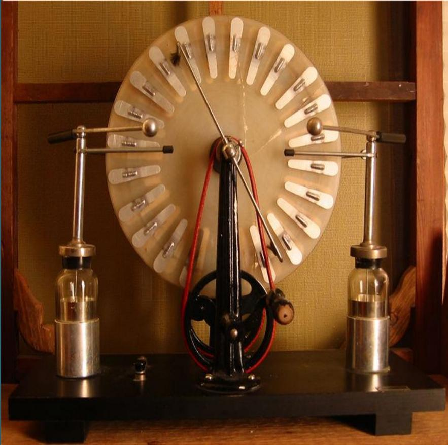
Действие основано на электризации трением. Наиболее эффективный из источников *электрофорная машина* (диски машины приводятся вращением в противоположных направлениях. В результате трения щеток о диски на кондукторах машины накапливаются заряды противоположного знака)
