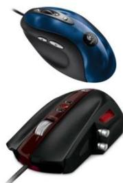
**Манипулятор «Мышь»** - механический **манипулятор**, преобразующий движение в управляющий сигнал.
