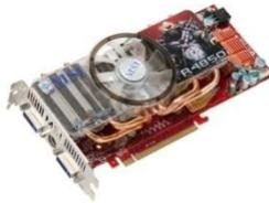
**Видеокарта (видеоадаптер)**- устройство, осуществляющее подготовку информации для ее отображения на экране монитора.
