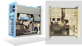
**Системный блок** - это корпус, в котором находятся различные функциональные компоненты компьютера
